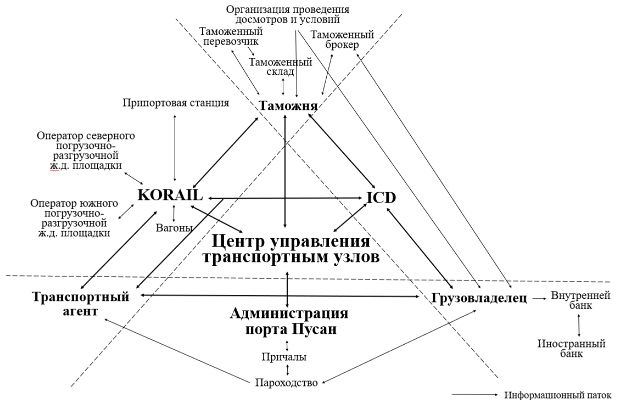
Рисунок 8 – Предлагаемая схема движения информационных потоков в транспортном узле Пусан с единым центром управления
